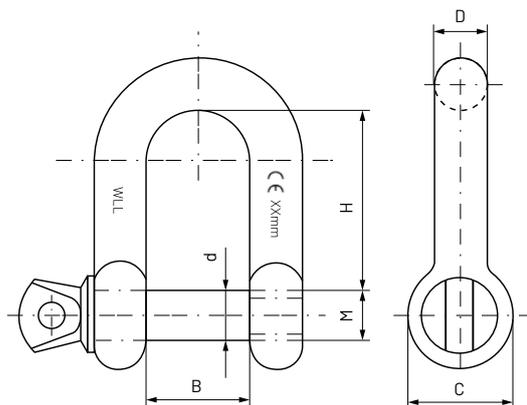
El grillete recto es el instrumento de elevación que más frecuentemente se utiliza como pieza intermedia entre una anilla, cáncamo o gancho y una eslinga.
