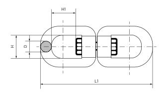
Las anillas giratorias, están especialmente indicadas para aplicaciones donde la elevación de cargas, elementos a transportar o amarrar, precisen de movimientos direccionales opuestos entre ambos extremos evitando las anillas giratorias que la cadena o cabo se retuercen.
